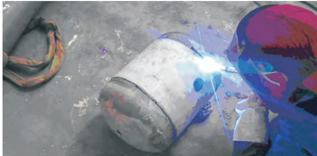
Сварка корня шва сосуда высокого давления из нержавеющей стали DC400RW-WD
